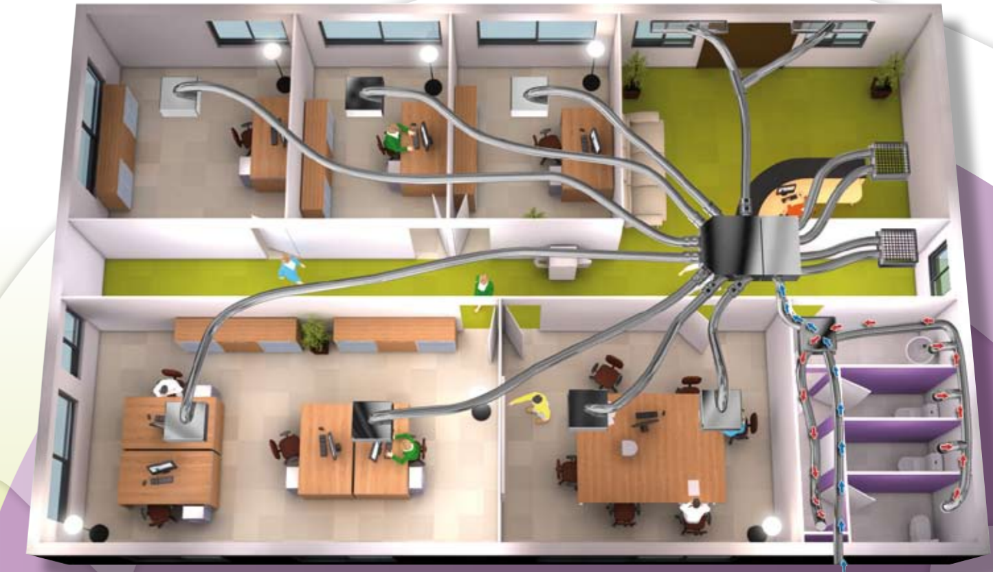
Registres motorisés OST circulaires tout ou peu Motorisation 24V par vérins thermiques.
